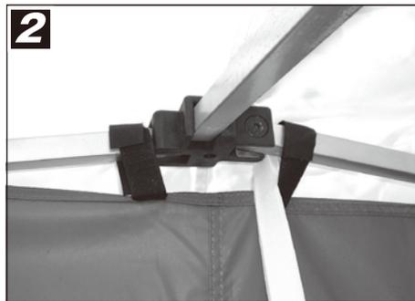
2 横幕をお好みの高さになるように合わせ、横幕上部のマジックテープをフレームのトラス部分に巻き付けます。
