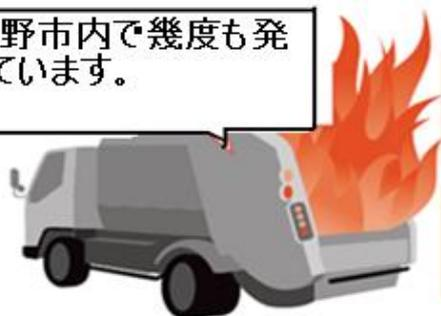
中身の残ったカセットボンベを**ごみ収集車**が回収すると**車両火災の原因**となります。
